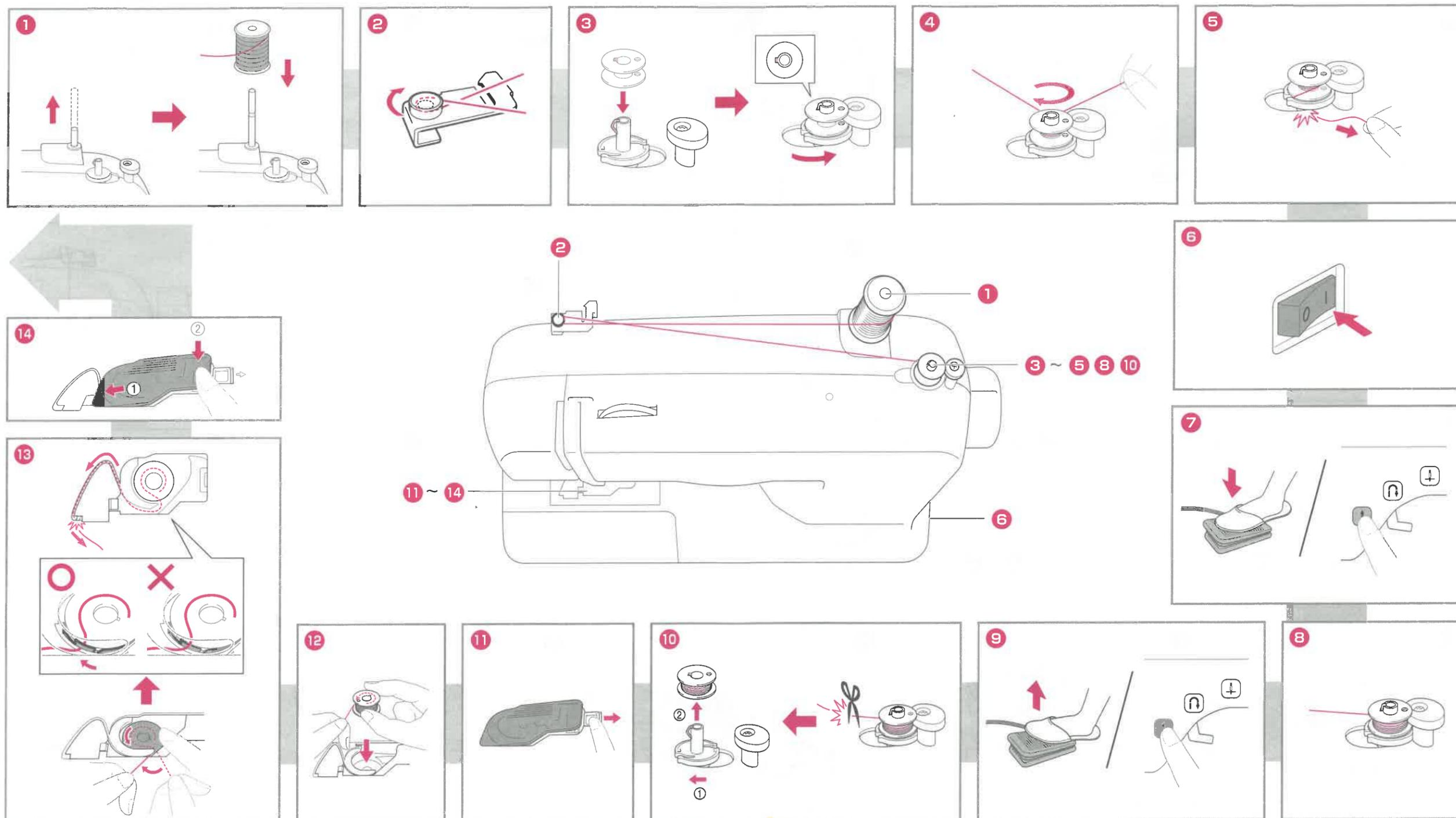
Quick Start Guide 2 – Upper threading – / Guide de démarrage rapide 2 – Enfilage supérieur – / Kurzanleitung 2 – Oberfadenführung –
